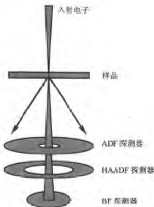
图 6.69 STEM 模式中探测器的示意图
