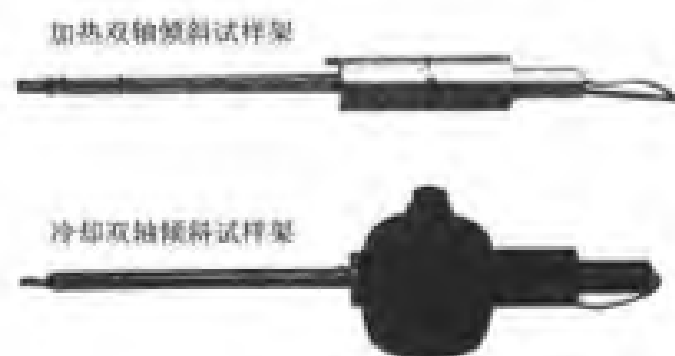
图 1.11 加热和冷却侧插式样品架外观
