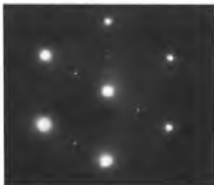
图 3.61 Inconel 718 合金基体 \gamma 和 \gamma' 相的 [111] 晶带的电子衍射花样
