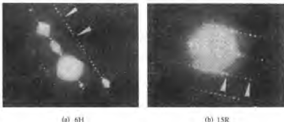
图 3.71 SiC 多型体的 [010] 电子衍射花样
