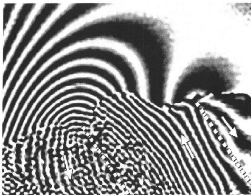
图 5-22 从全息图像(图 5-20(b))再生的相位像(箭头示出了磁力线的方向)
