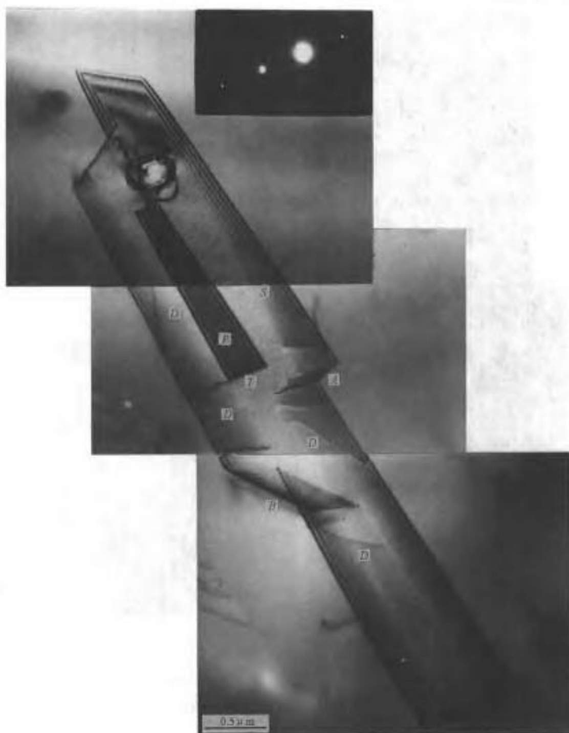
照片 70 91Ti 不锈钢中的孪晶界特征
