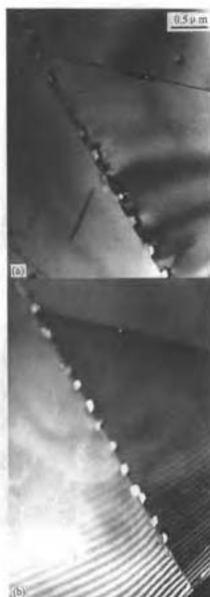
照片 62 \gamma' 在高温合金 晶界均匀析出
