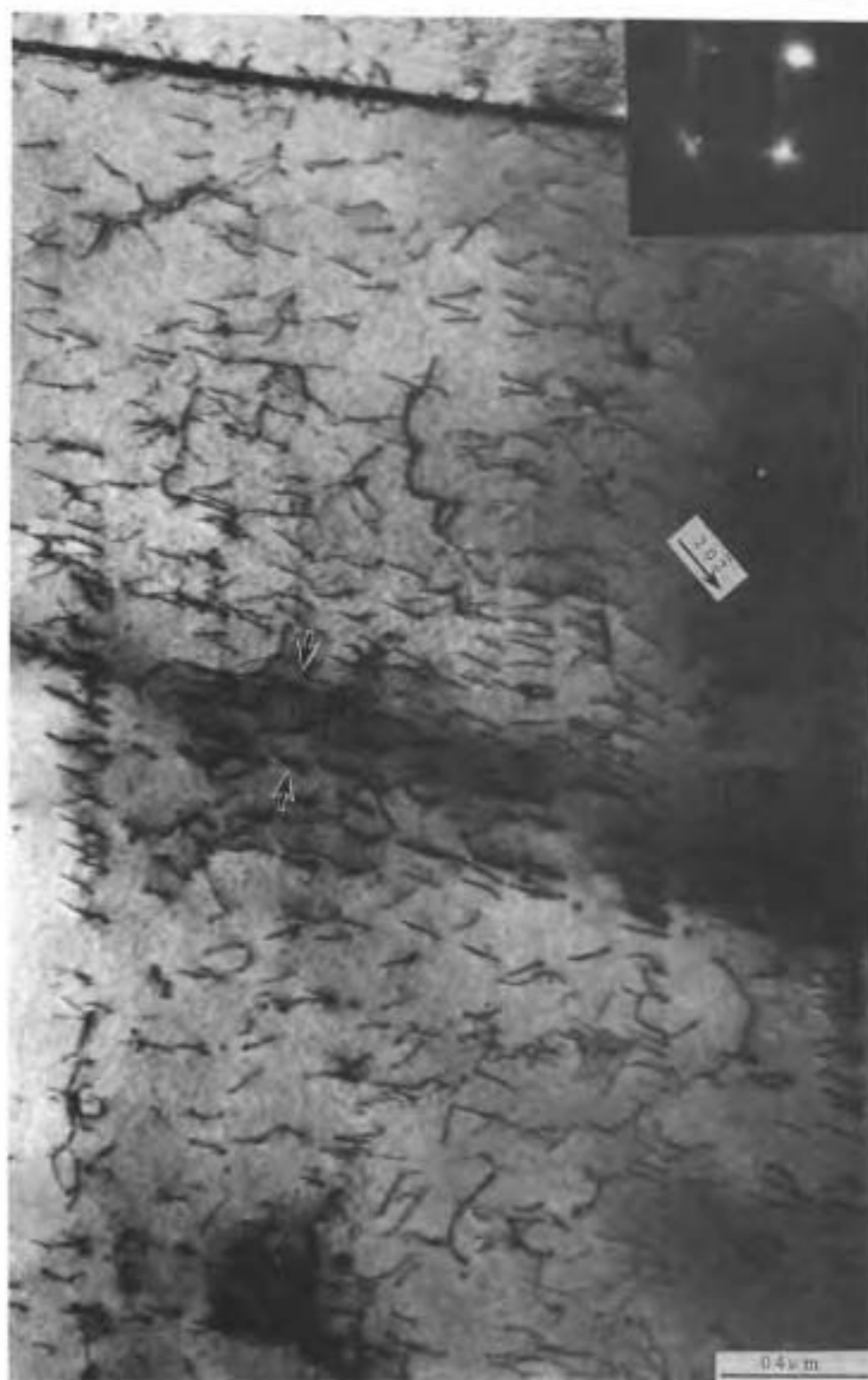
照片75 Ni基耐热合金的形变结构
