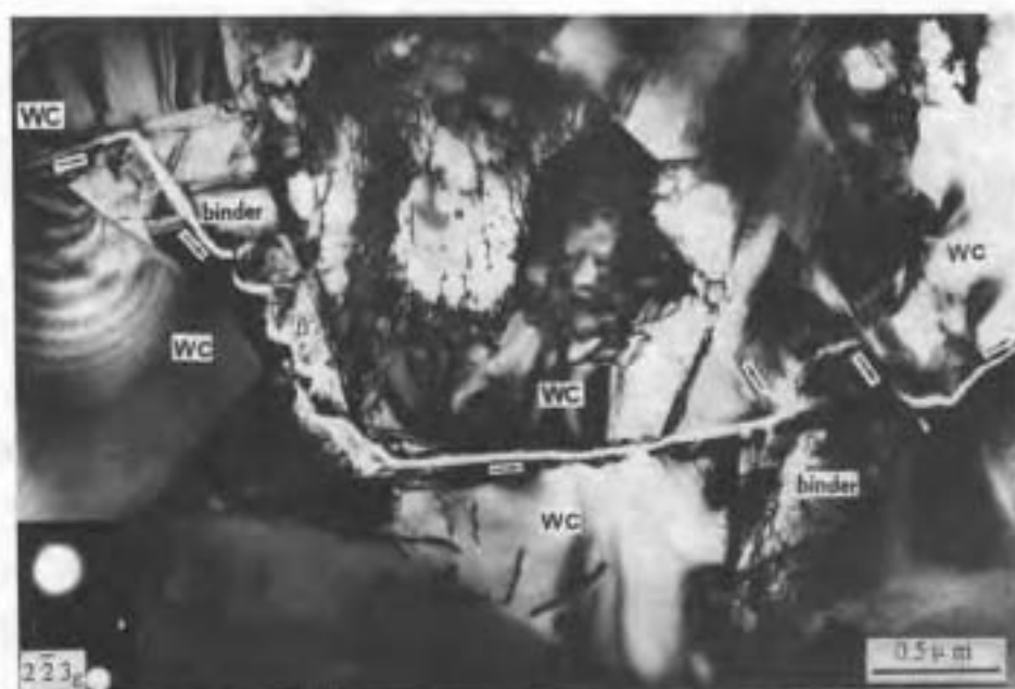
照片13 WC-12%Co合金中裂纹扩展过程 在多滑移系统的 \beta -Co[在合金中作为粘模相(binder)]中, 裂纹呈“Z”字形路径扩展; 在hcp的WC中, 在WC/WC界面, 主要以直线形式传播。左下为裂纹传播路径示意图。
