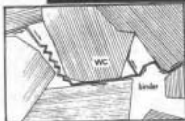
照片13 WC-12%Co合金中裂纹扩展过程 在多滑移系统的 \beta -Co[在合金中作为粘模相(binder)]中, 裂纹呈“Z”字形路径扩展; 在hcp的WC中, 在WC/WC界面, 主要以直线形式传播。左下为裂纹传播路径示意图。
