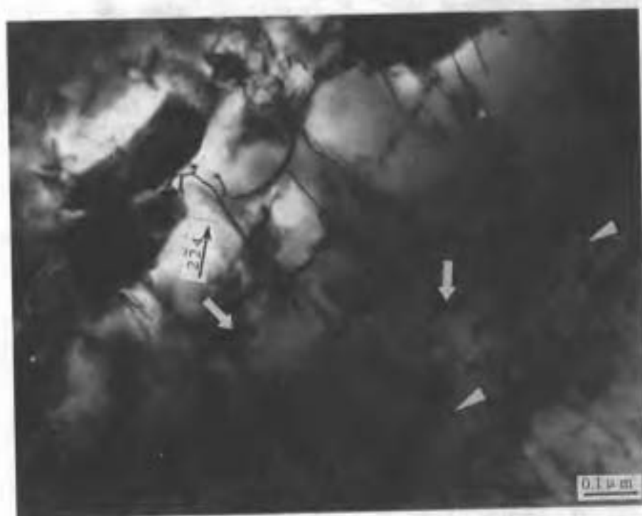
照片 32 超高强度钢 30CrMnSiA 中的蠕变位错结构 照片上可看到位错割阶 (274) 和攀移留下的印迹 (275)。
