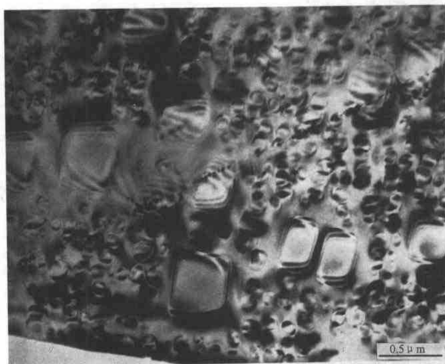
照片 30 Nimonic 超合金中的 \gamma/\gamma' 基体共格应变衬度
