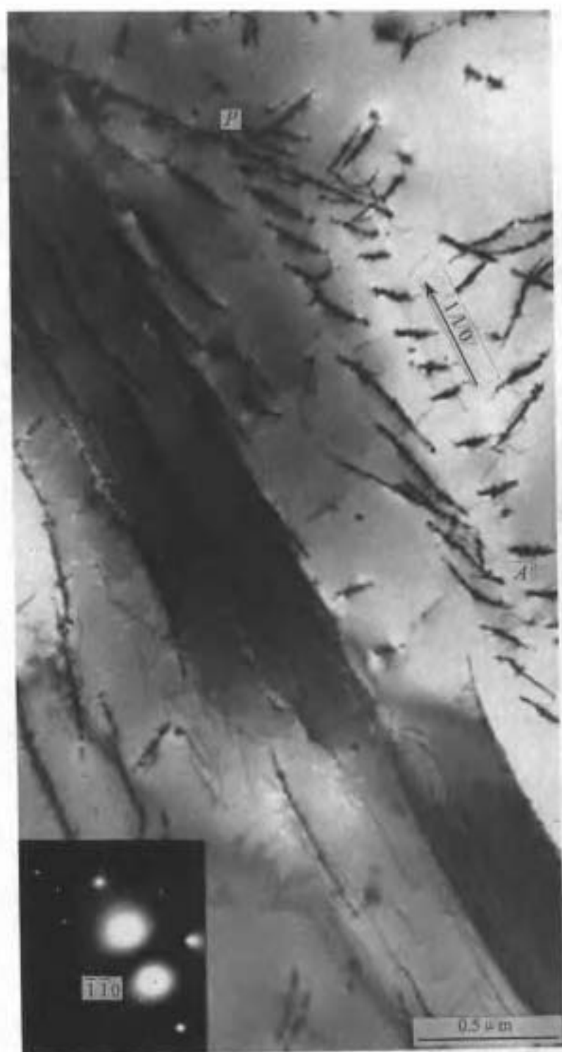
照片 76 高温合金 (6.5%Al - Ni) 的位错组态 (1150°C 退火, 水淬; 2.8%拉伸)
