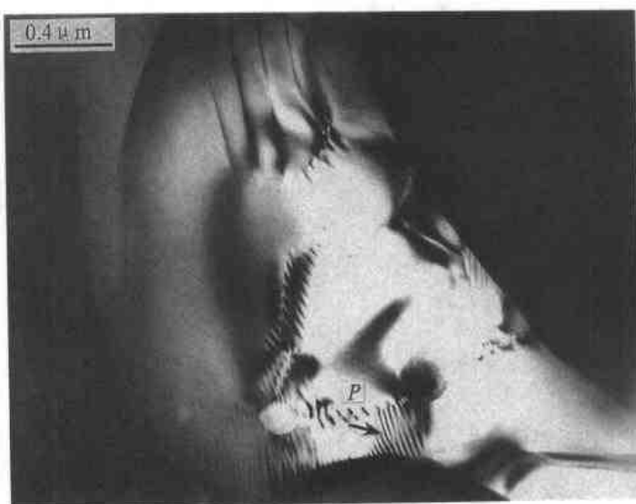
照片 89 \text{Al}_2\text{O}_3/\text{SiC} 陶瓷中 \text{Al}_2\text{O}_3 基体的显微结构 SiC 颗粒(P处, 其左侧已脱落)边缘和 \text{Al}_2\text{O}_3 薄层形成的波纹图。箭头所示处显现出一根垂直于膜面的刃位错。
