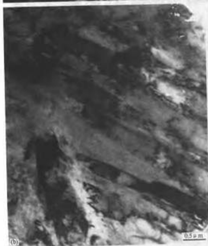
照片 39 18Ni 马氏体时效钢的微观结构 (a) 840^{\circ}\text{C} \times 30' + 480^{\circ}\text{C} \times 20' + 520^{\circ}\text{C} \times 1\text{h} 。 (b) 840^{\circ}\text{C} \times 30' 炉冷，典型的位错板条马氏体。 (a) 图可见高位错密度和弥散析出相 \text{Ni}_3\text{Mo} 。
