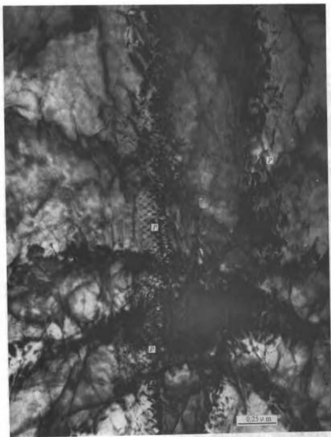
照片 78 18/8CrNi 不锈钢弯曲膜[101]多束图 注意在照片中部 s=0 附近由于异常透射, 显示出结构细节(位错网)的良好衬度(P所示)。
