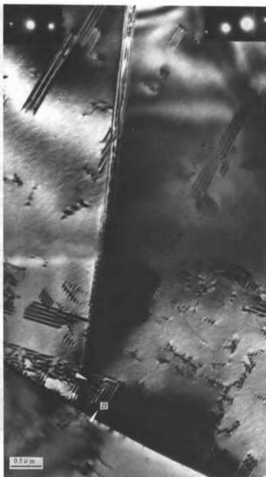
照片 33 不锈钢中孪晶界及孪晶内的位错组态 (1150℃, 1.5h 固溶后 2.0% 拉伸形变)
