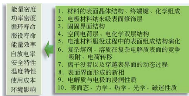
图4 电池中表界面问题对电池性能的影响图示
