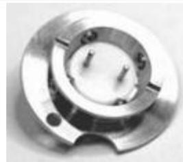
将上述组件放入对中圈内，调整另一组四个螺钉，使灯丝组件与对中圈同心。调好后，拧紧四个螺钉。注意固定盘上的缺口和小孔要与对中圈上的销和槽对齐。
