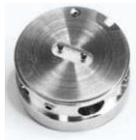
将弹簧片放入栅极帽内，再放入上述组件，利用调节圈锁紧，见左图。将组件翻转，使栅极帽内孔向上，观察钨尖是否在孔中心，可以重复上述调整步骤，使钨尖位于孔中心，最好在体视显微镜下调整，转动栅极帽，从两个方向判断钨尖是否调整到孔心。
