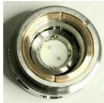
手持整个组件，转动调节圈，使钨尖与栅极帽大平面同高。反时针转动调节圈1圈加1/4圈，钨尖缩入下表面0.6mm，见下图。每次更换灯丝均要保证这个缩入量。也可以反转3/4圈，增加灯丝发射束流，分辨率可适当改善，但灯丝寿命可能略短。
